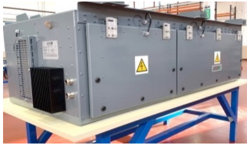
Convertisseur de puissance auxiliaire
