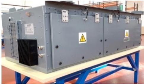
Convertisseur de puissance auxiliaire
